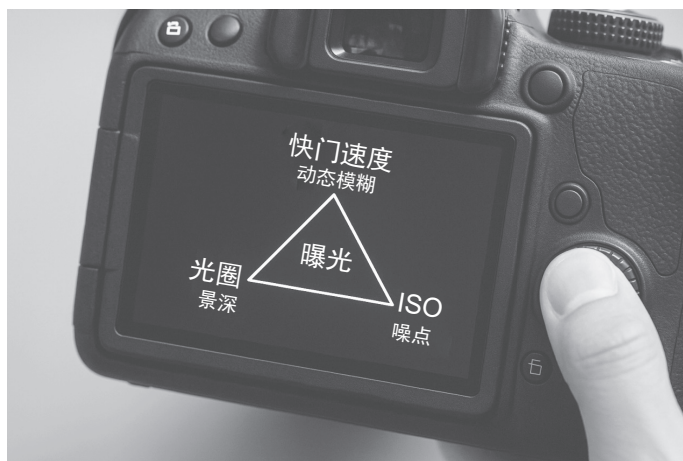
图 3-4 快门速度、光圈、ISO 的关系
