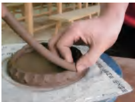
图 2-79 拇指按下泥条边缘，食指在另一侧做辅助
