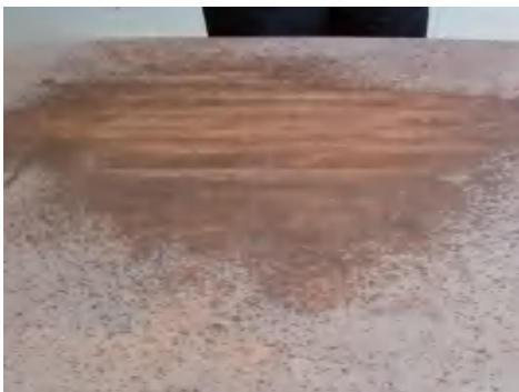
图 2-67 如果工作台干燥的话，需要把它喷湿，防止板面吸走泥料的水分
