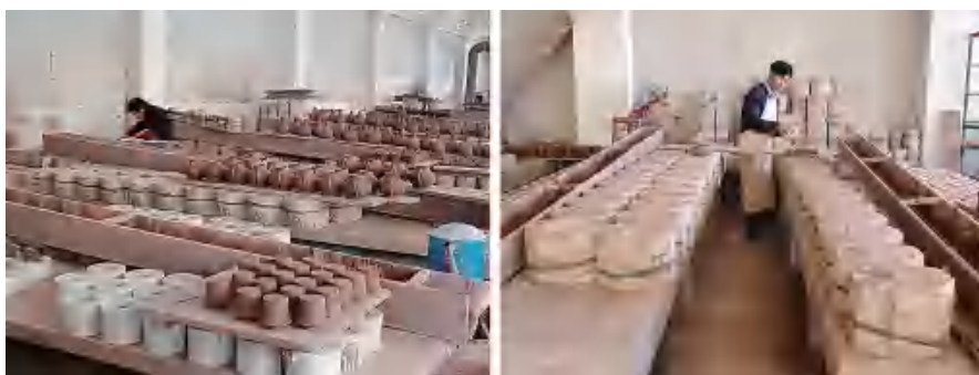
图 2-149 注浆成型生产车间
