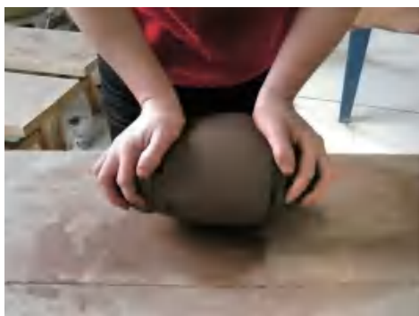
图 2-39 把泥揉熟后，双手力量向中心靠拢，逐渐减力，速度加快
