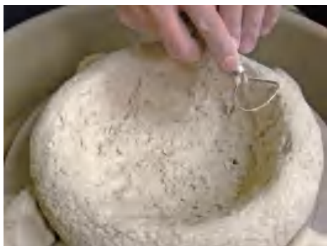
图 5-100 把泥坯固定在修坯机上修坯
