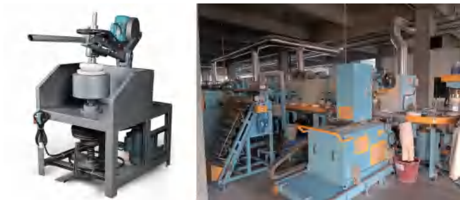
图 2-142 压坯机及压坯生产线
