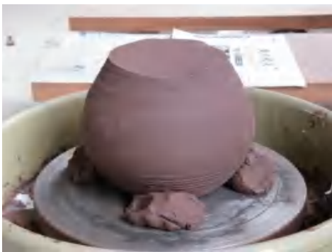
图 2-140 开始修坯:把半干的坯体倒放在拉坯机上,与转盘同心。把可塑性好的泥料块粘在转盘上,与坯体贴紧固定好
