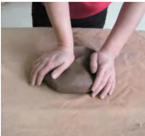
图 2-95 按所需泥量把揉好的泥料放在布上，身体前倾，用手掌将泥料推压平整
