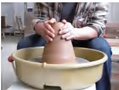
图 2-130 将拉起的泥料再按下去，反复几次，使泥料在拉坯机上处于居中状态
