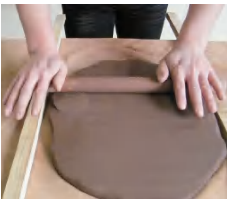
图 2-102 再用擀泥棒用力擀压
