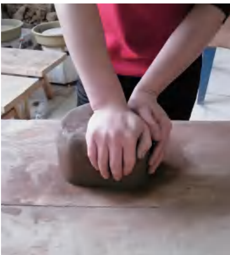
图 2-41 先取一块泥料，不宜过多，越多越不好掌控
