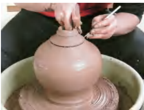
图 2-138 基本造型已经完成,这时需要收口,用钢针从侧面伸进去将不齐或多余的泥切掉,再修整口沿儿
