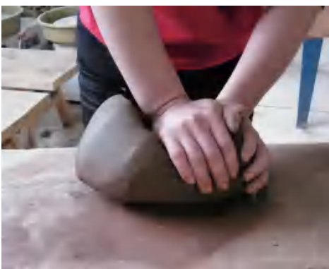
图 2-43 身体前倾，右手掌向左下方挤压，由外向中心用力
