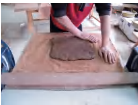
图 2-106 用手掌将泥料推压平整，厚度略高于压轮底高
