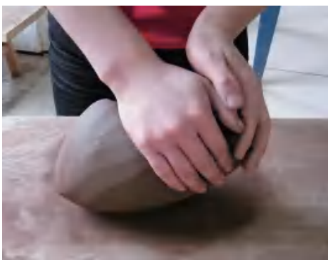
图 2-48 把泥揉匀后，双手下压力量逐渐减弱，速度逐渐加快
