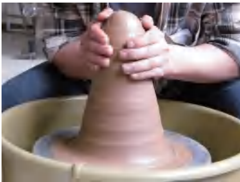
图 2-129 开动拉坯机，在泥上淋水，保证泥表面的光滑度，然后双肘放在大腿上，双手握住泥料，使双臂成稳定的三角形后将其拉起
