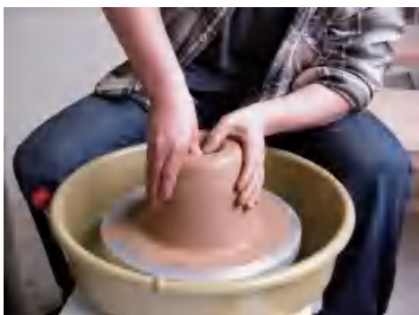
图 2-132 将伸下去的拇指向外用力，将开口拉大
