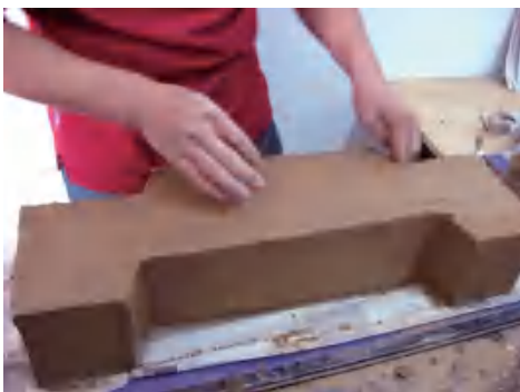
图 2-119 检查所有的黏合处，看是否有没粘紧的地方
