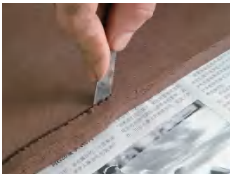
图 2-111 把需要黏合在一起的边切成斜边，切去的泥条角度在 30~40 度之间
