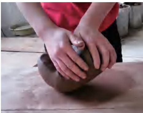
图 2-46 扶起的同时右手前移拉回泥料，再以顺时针方向转一下
