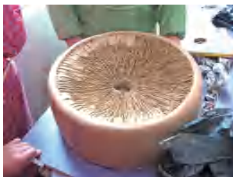
图 5-62 用工具对坯体划出发射线线条
