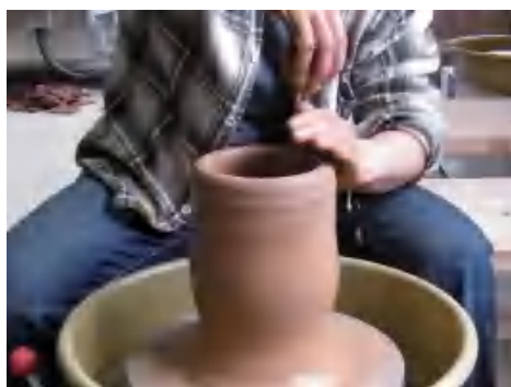
图 2-135 在泥料表面摩擦力增大时，需要在表面再淋水，以保证润滑度
