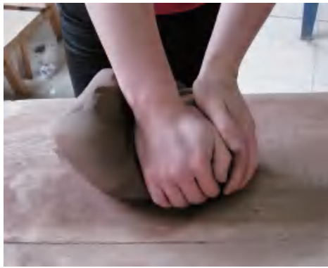
图 2-44 两只手像打太极一样，右掌下压，前推，手腕向前躬，手掌带动泥料；左手在侧面辅助
