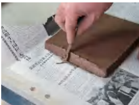
图 2-112 把已经切好的边刮粗糙，然后涂抹泥浆来加强黏合力
