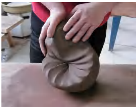
图 2-47 几个动作反复多次，泥料中的气泡就会在褶皱处被挤破排出
