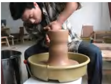
图 2-134 两只手一里一外，里高外低，控制好两只手的距离，将泥料拉起，呈泥筒状
