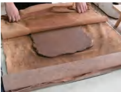
图 2-109 转动压轮，泥料在压轮中反复数次，泥板就压制好了
