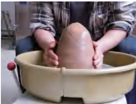
图 2-128 将已经揉好的泥料稍用力向静止的拉坯机转盘中心落下，让泥料与转盘牢固地粘在一起
