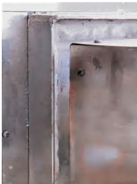
图 4-8 水分蒸发阶段窑门不能完全关闭
