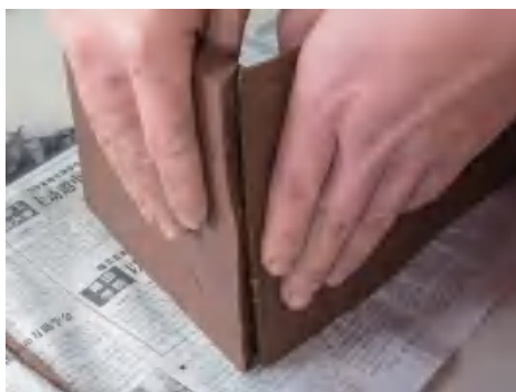
图 2-113 把需要黏合的两个面前后交错，反复几次，直到两个面粘在一起
