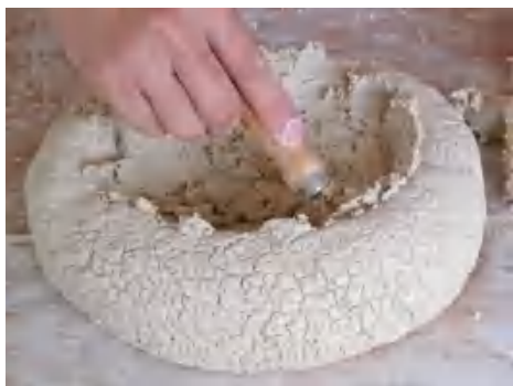
图 5-99 用工具将泥饼挖出容器
