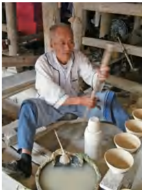
图 5-15 将修坯机旋转起来
